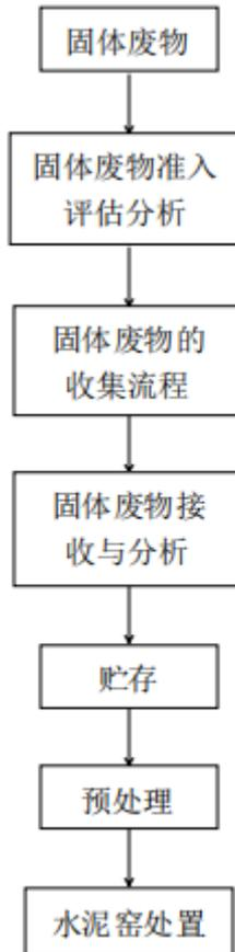
图 2.4-3 水泥窑协同处置危险废物流程图
