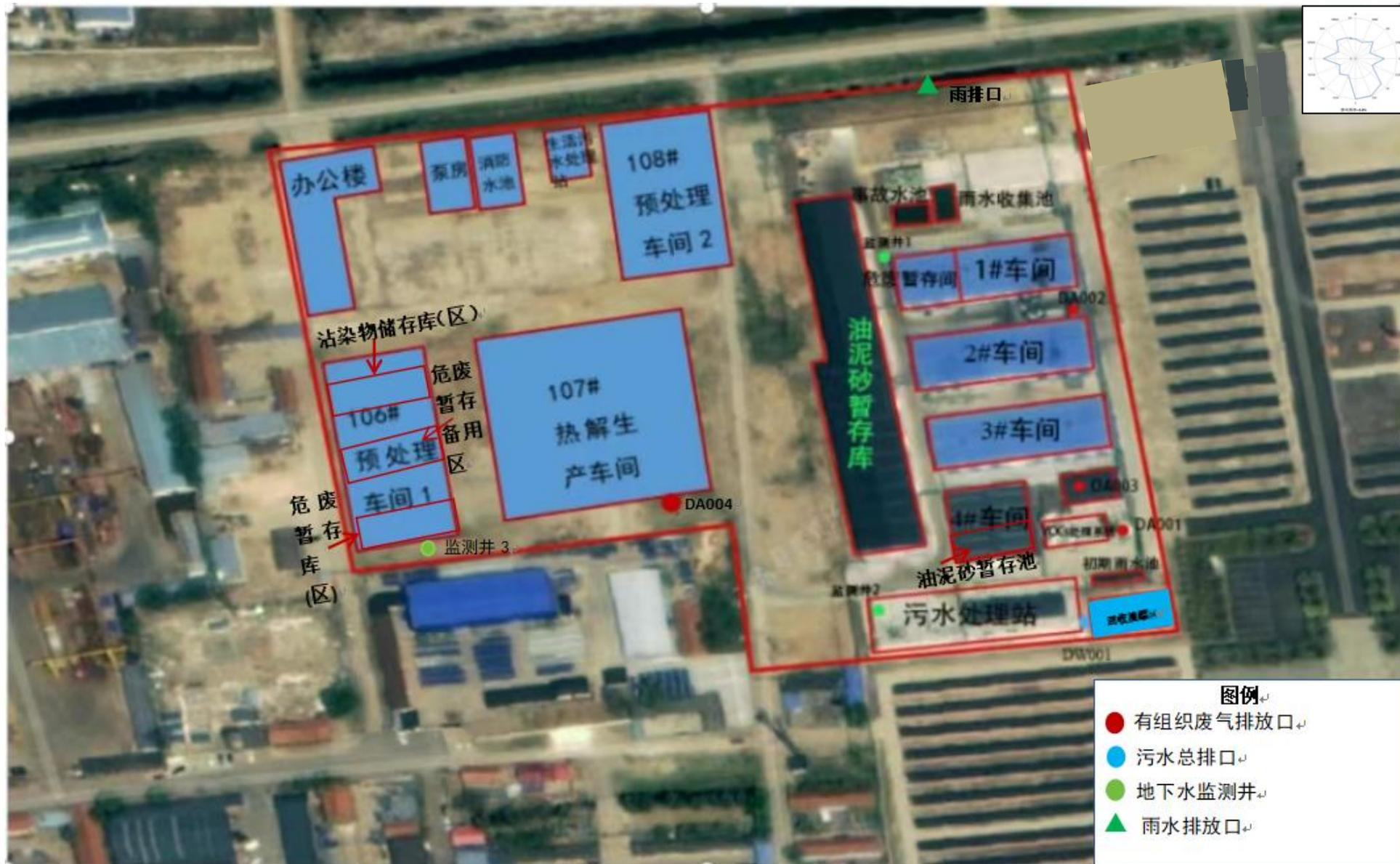
图 3-3 厂区平面布置图（比例尺 1:300）
